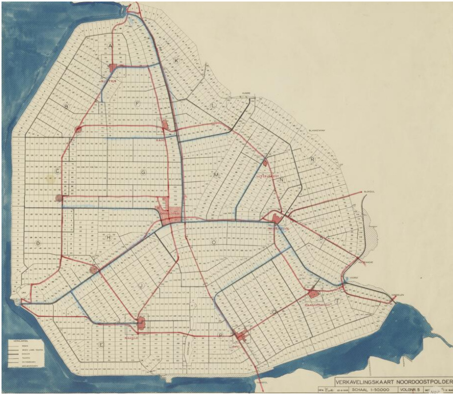
Afb. 7.25 De Verkevelingskaart voor de Noord-oostpolder. De verkavelingsstructuur is ontworpen om optimaal aan te sluiten bij de moderne landbouw zoals die destijds als wenselijk werd beschouwd. De dorpen liggen op 'fietsafstand' in een radiale structuur, met Emmeloord - de grootste woonkern met meer voorzieningen - in het midden.
