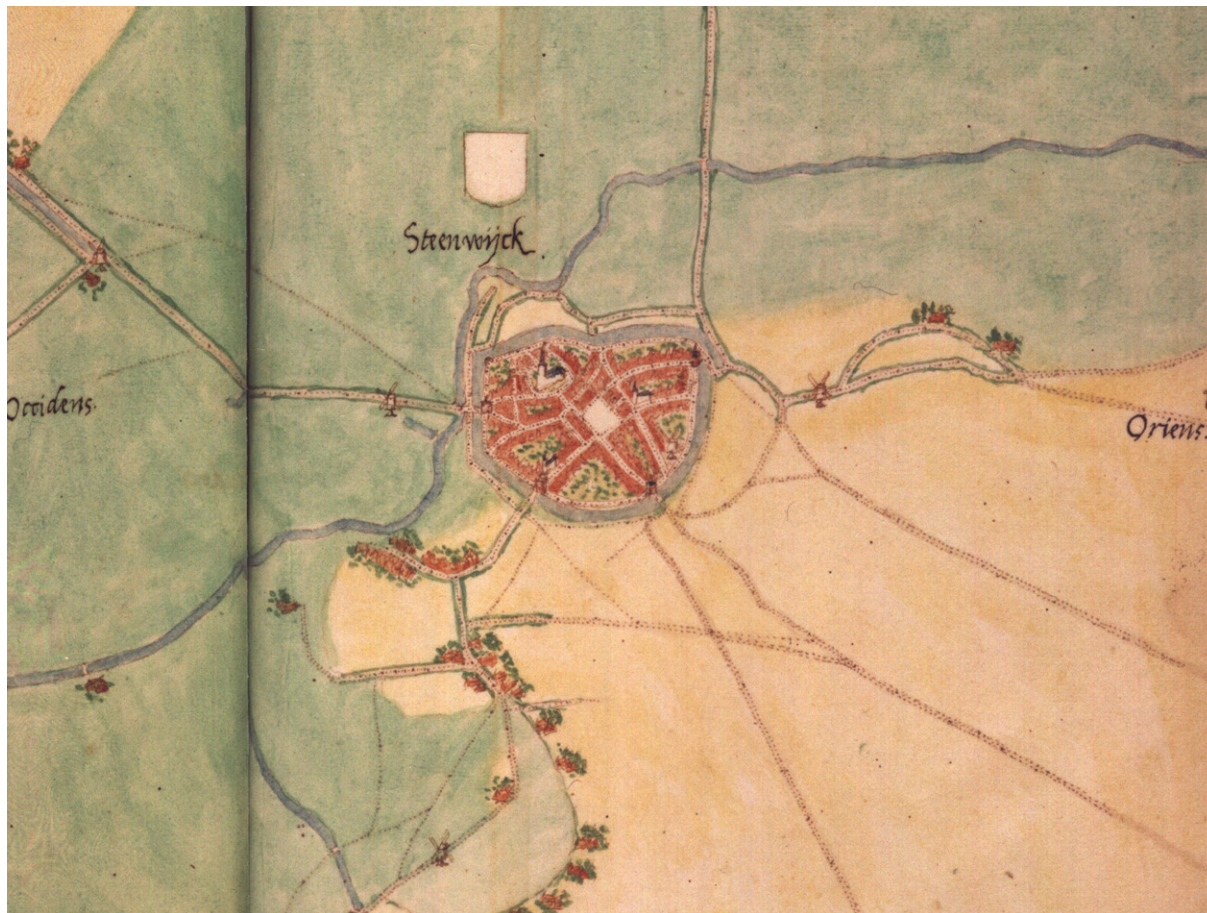
Afb. 2.10 - Steenwijk is ontstaan op de plek waar het keilleem en het veengebied elkaar raken. De Steenwijker Aa zorgt voor verbinding met het bovenstroomse veengebied, het Steenwijker Aa staat in contact met de Zuiderzee. De stad heeft door zijn ligging controle over de doorgaande weg op de keileemruggen, maar ook op het laaggelegen veengebied, dat daar op zijn smalst is. Dit is één van de oudste kaarten van Steenwijk door de cartograaf Van Deventer uit omstreeks 1560.
